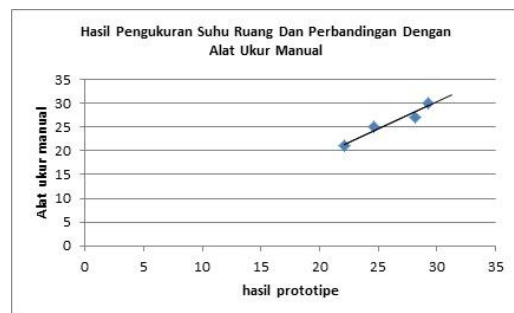
Gambar 20 Hasil Pengukuran Suhu Ruang Dan Perbandingan Dengan Alat Ukur Manual
