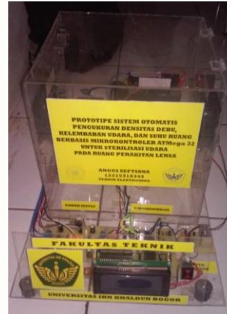
Gambar 12 Bentuk fisis prototipe sistem otomatis pengukuran densitas debu, kelembaban udara dan suhu ruang
