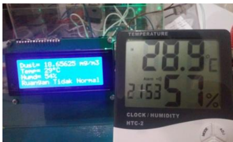
Gambar 11 Perbandingan Pengukuran Dengan Alat Ukur Terstandar
