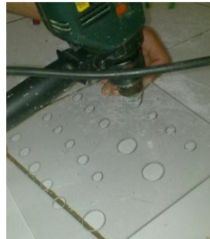
Gambar 11. Proses pengeboran panel
