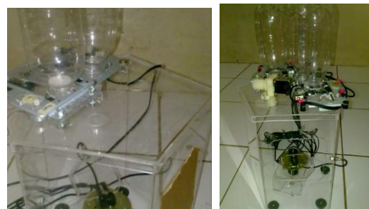
Gambar 9. Perakitan tutup body dan tabung penampung
