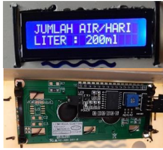
Gambar 3.6 Bentuk fisis LCD 1602
