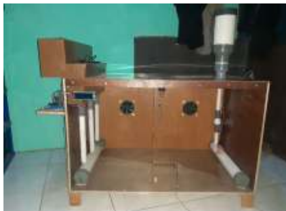
Gambar 3.1 Bentuk Fisis Prototipe Feeding System dan Pengatur Suhu pada Kandang Ayam
