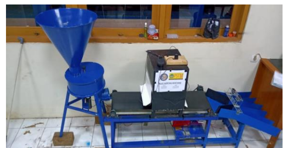
Gambar 4. Mesin sortasi kentang
